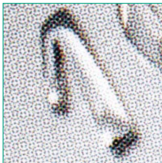
vergrößerter Scan vom Offsetdruck mit 70er Raster
