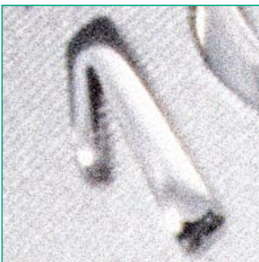
vergrößerter Scan vom Offsetdruck mit frequenzmoduliertem Raster
